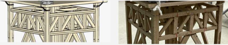
벨트트러스 & 아웃리거 제작 시 코어와 기둥 제작 후 남은 부재 활용 (경제성)
